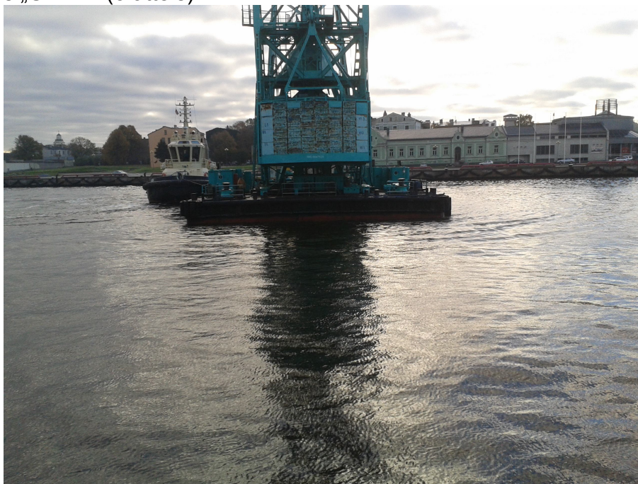
5.attēls. Peldošā celtna pārvietošana akvatorijā ar velkoni „URAN”.
